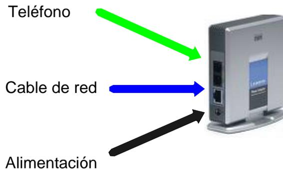
Una vez conectados todos los cables podrás ver en los indicadores de luz de la propia caja si está funcionando o no. Tienen que estar encendidas por lo menos las luces
